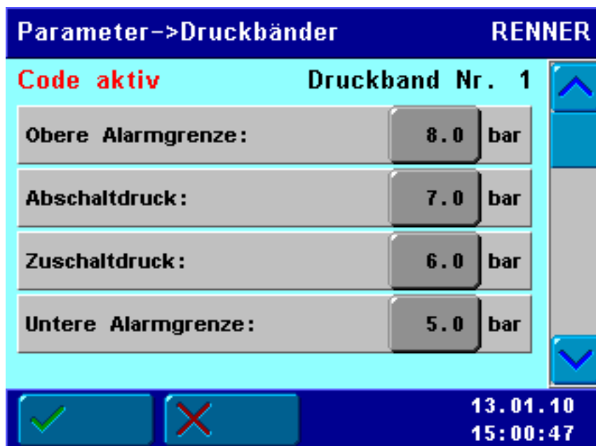
Рис. 10: пример настройки диапазона давления № 1
